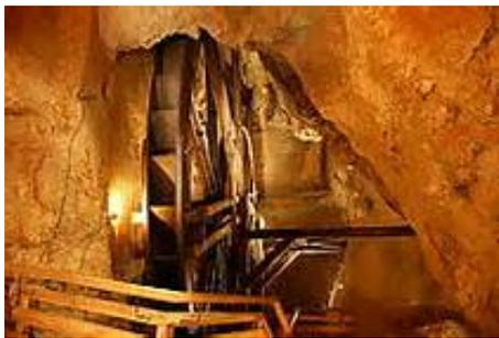
Die Wasserkunst bestand aus einem Kehrtrad, welches ober-schlächtig angetrieben wurde sowie einem Gapelrad. Das Kehrtrad wurde vom Wasser des Bucher Baches angetrieben, wofür ein 4 km langes Holzrinnwerk durch den Berg gelegt werden musste. Der Wassertransport wurde mittels Ochsenhaut-Säcken (sogenannten „Bulgen“) durchgeführt, Erz konnte in kupfernen Tonnen gefördert werden.
