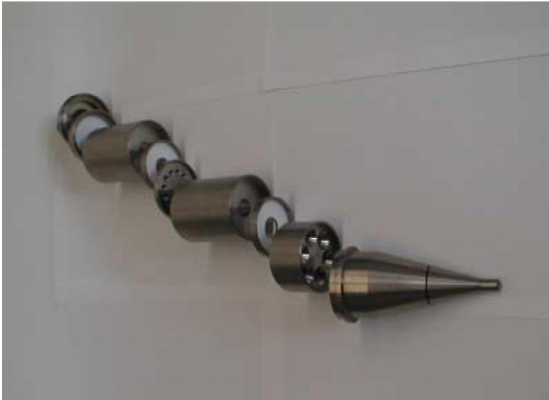
**Abbildung 6-2:** Einzelne Module des GMU - Impaktors *johnas*
