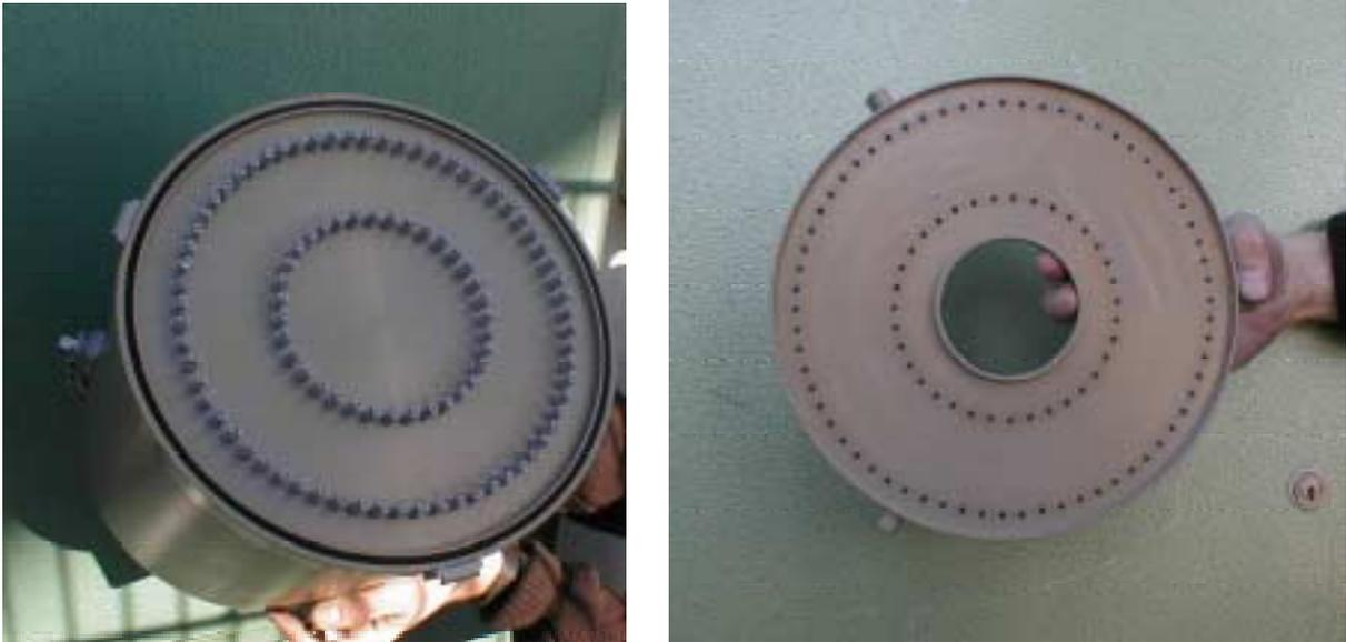
**Abbildung 3-4:** Düsenplatte und Prallplatte des PM 1-Impaktors
