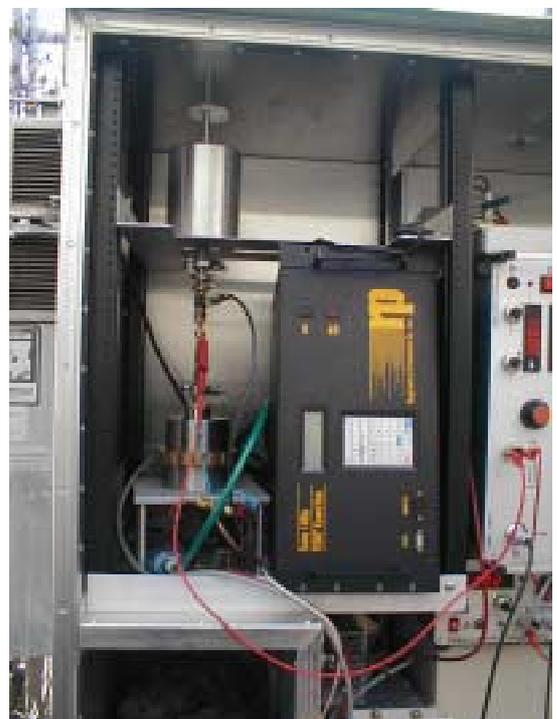
**Abbildung 4-3:** Immissionsprobenahmesystem in der Klimakammer, rechts daneben die Steuereinheit des TEOM®-Gerätes und die 2 Hochspannungsquellen für Auflader und ESP.
