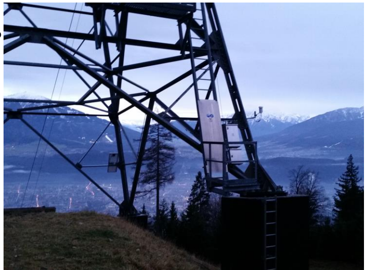
Abbildungen A13-A15: Tempis Station Rastboden (RAS). A13 (oben): Satellitenfoto 3D mit Standortmarkierung im oberen Bilddrittel (Quelle: Google Maps). A14 (Mitte): Satellitenfoto 3D Zoom, Tempis Standort auf der Stütze der Seegrubenbahn ist mit gelbem Punkt markiert. A15 (unten rechts): Stütze mit Temperatur- und Feuchtesensor auf dem horizontalen Ausleger 6.5 m über Grund rechts an der Stütze.
