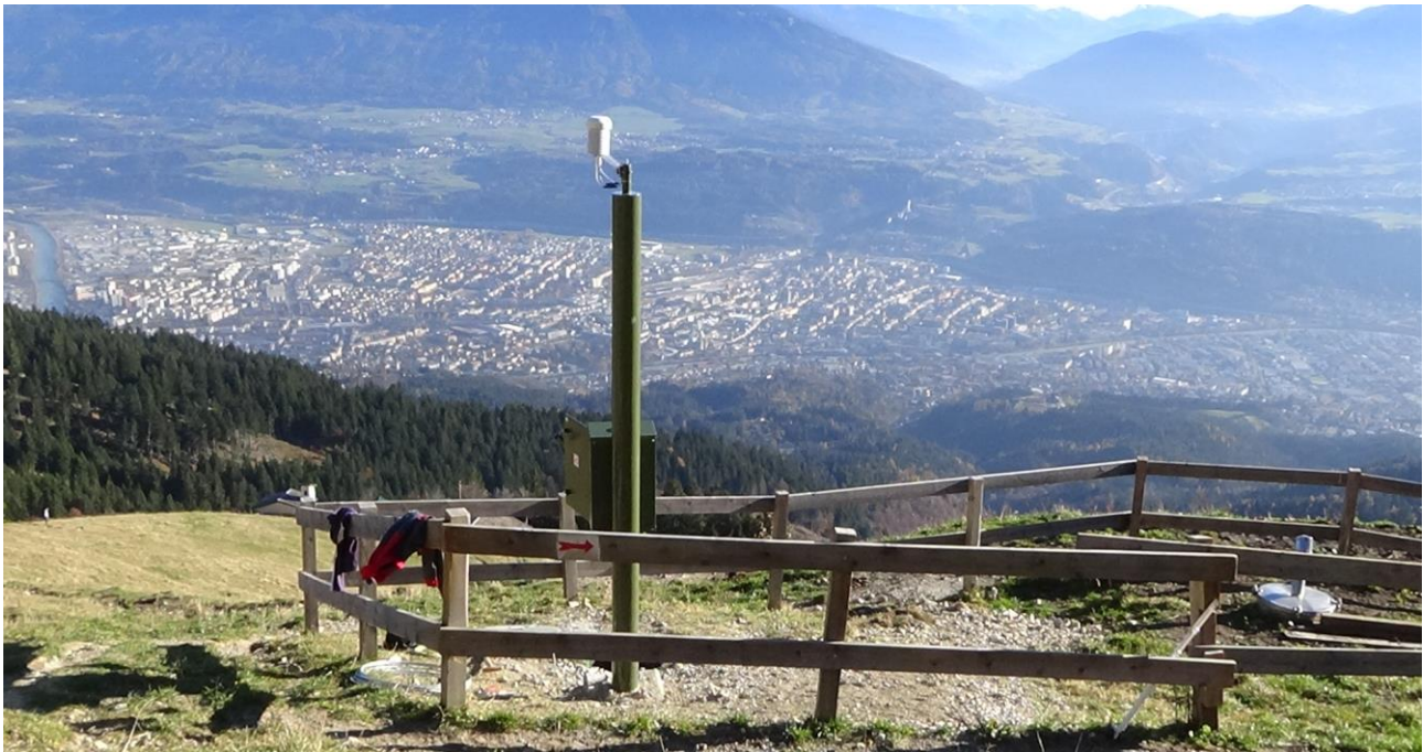
Abbildungen A16-A18: Tempis-Station Höttinger Alm (HOE). A15 (oben): Satellitenfoto 3D mit Standortmarkierung (Quelle: Google Maps). A17 (Mitte): umzäunter Mast oberhalb der Stadt Innsbruck. A18 (unten links): 3 m Mast mit Temperatur- und Feuchtesensor, sowie (geöffnetem) Elektronik-Kasten. Auf allen drei Abbildungen sind die freien Almflächen gut erkennbar.
