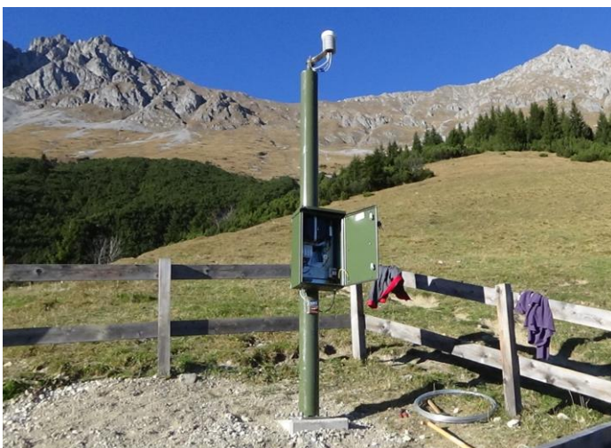
Abbildungen A16-A18: Tempis-Station Höttinger Alm (HOE). A15 (oben): Satellitenfoto 3D mit Standortmarkierung (Quelle: Google Maps). A17 (Mitte): umzäunter Mast oberhalb der Stadt Innsbruck. A18 (unten links): 3 m Mast mit Temperatur- und Feuchtesensor, sowie (geöffnetem) Elektronik-Kasten. Auf allen drei Abbildungen sind die freien Almflächen gut erkennbar.
