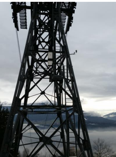
Abbildungen A10-A12: Tempis-Station Hungerburg (HBG). A10 (oben): Satellitenfoto 3D mit Standortmarkierung im oberen Bild Drittel (Quelle: Google Maps). A11 (Mitte): Satellitenfoto 3D Zoom, Tempis Standort auf der ersten Stütze der Seegrubenbahn ist mit gelbem Punkt markiert. A12 (unten links): Stütze mit Temperatur- und Feuchtesensor auf dem horizontalen Ausleger in 11.5 m Höhe rechts an der Stütze.
