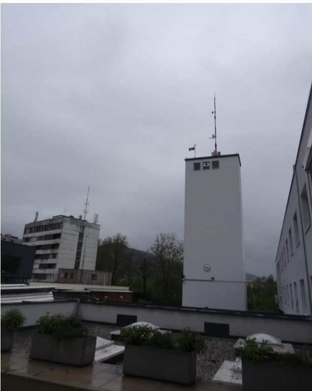
Abbildungen A1-A3: Tempis-Station Hauptbahnhof (HBF) auf dem Schlauchturm der Berufsfeuerwehr. A1 (oben): Satellitenfoto mit Standortmarkierung (Quelle: Google Earth). A2 (unten links): Schlauchturm mit 6 m Mast, Richtung SSW fotografiert. A3 (unten rechts): Mast mit Temperatur-, Feuchte- und Windsensor.
