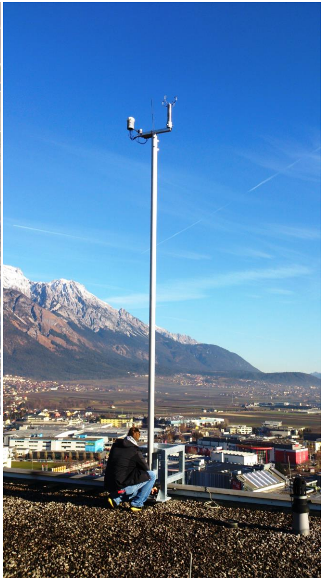
Abbildungen A4-A6: Tempis-Station Olympisches Dorf (ODO). A4 (oben links): Satellitenfoto mit Standortmarkierung (Quelle: Google Maps). A5 (oben rechts): Auf dem Dach, Blickrichtung Nordost ins Unterinntal. Auf dem 6 m Mast sieht man links Temperatur- und Feuchtesensoren, rechts den Ultraschall-Windsensor. A6 (unten): Satellitenfoto 3D (Quelle: Google Maps). In der Bildmitte gut erkennbar der gelb markierte Standort auf dem Hochhausturm.
