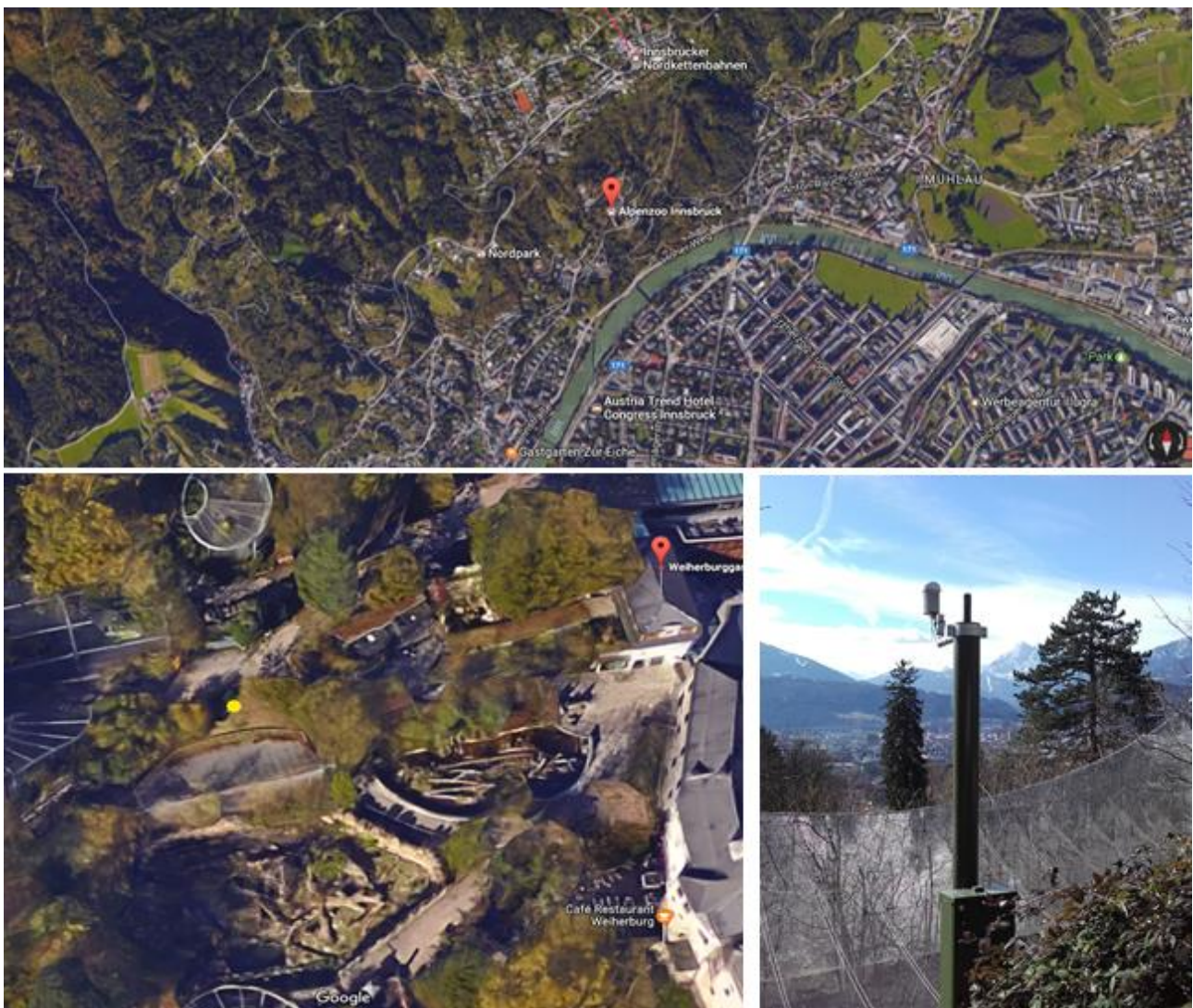
Abbildung A3: TEMPIS-Station Alpenzoo (ALP) am Hangfuß der Nordkette (oben, GoogleMaps, rot markiert) im Alpenzoo, oberhalb der Vogelvoliere (unten links, 3D-GoogleMaps, gelb markiert). Der 3 m hohe Mast mit Temperatur- und Feuchtesensor ist von Bäumen, Sträuchern und Zoogehegen umgeben.
