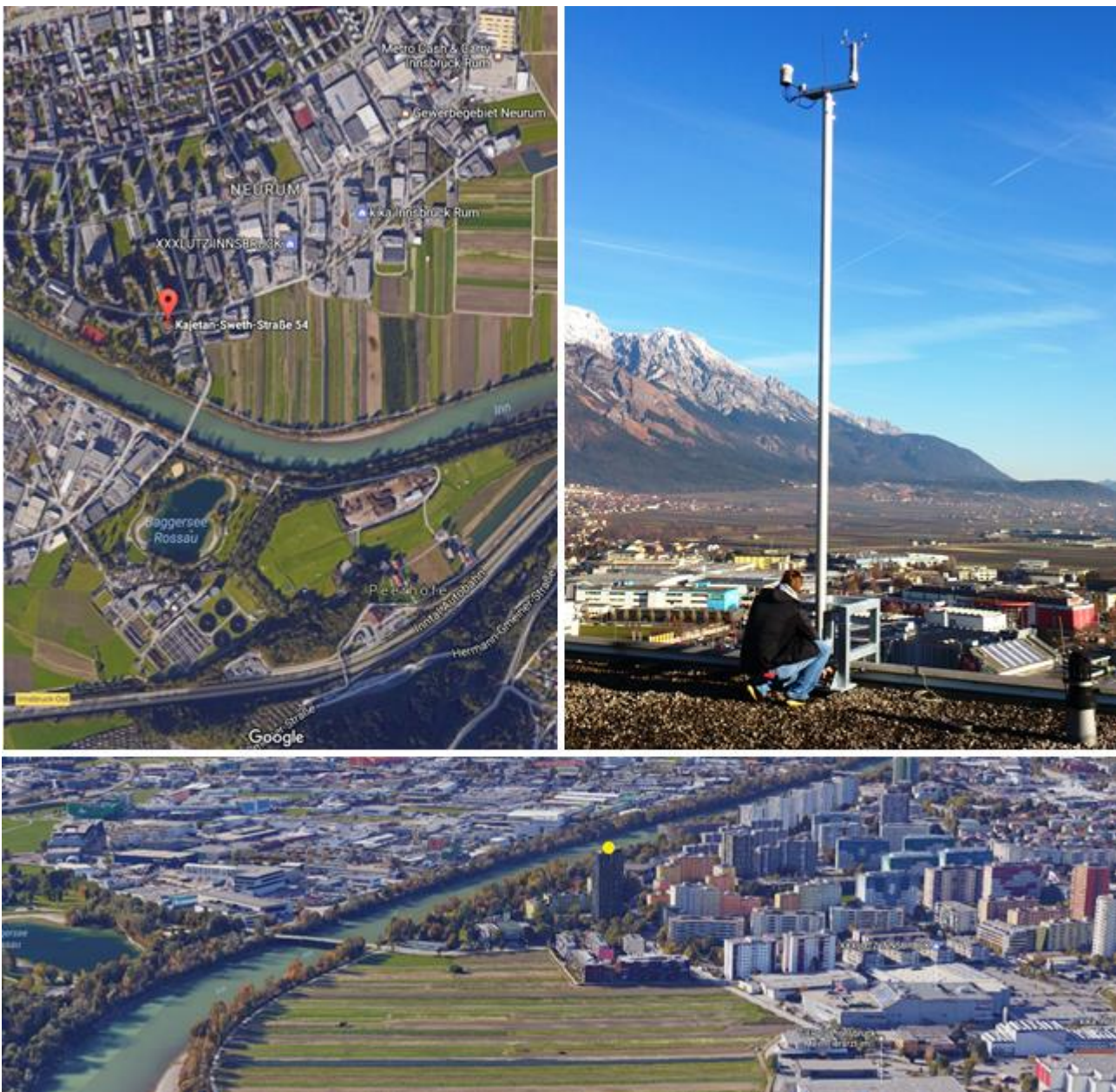
Abbildung A2: TEMPIS-Station Olympisches Dorf (ODO) am Ostrand der Stadt (oben links, GoogleMaps) auf einem ca. 60 m hohen Gebäude (unten, 3D-Ansicht aus Ost, GoogleMaps). Temperatur-, Feuchte- und Windsensor sind auf dem 6 m-Mast (oben rechts) angebracht.
