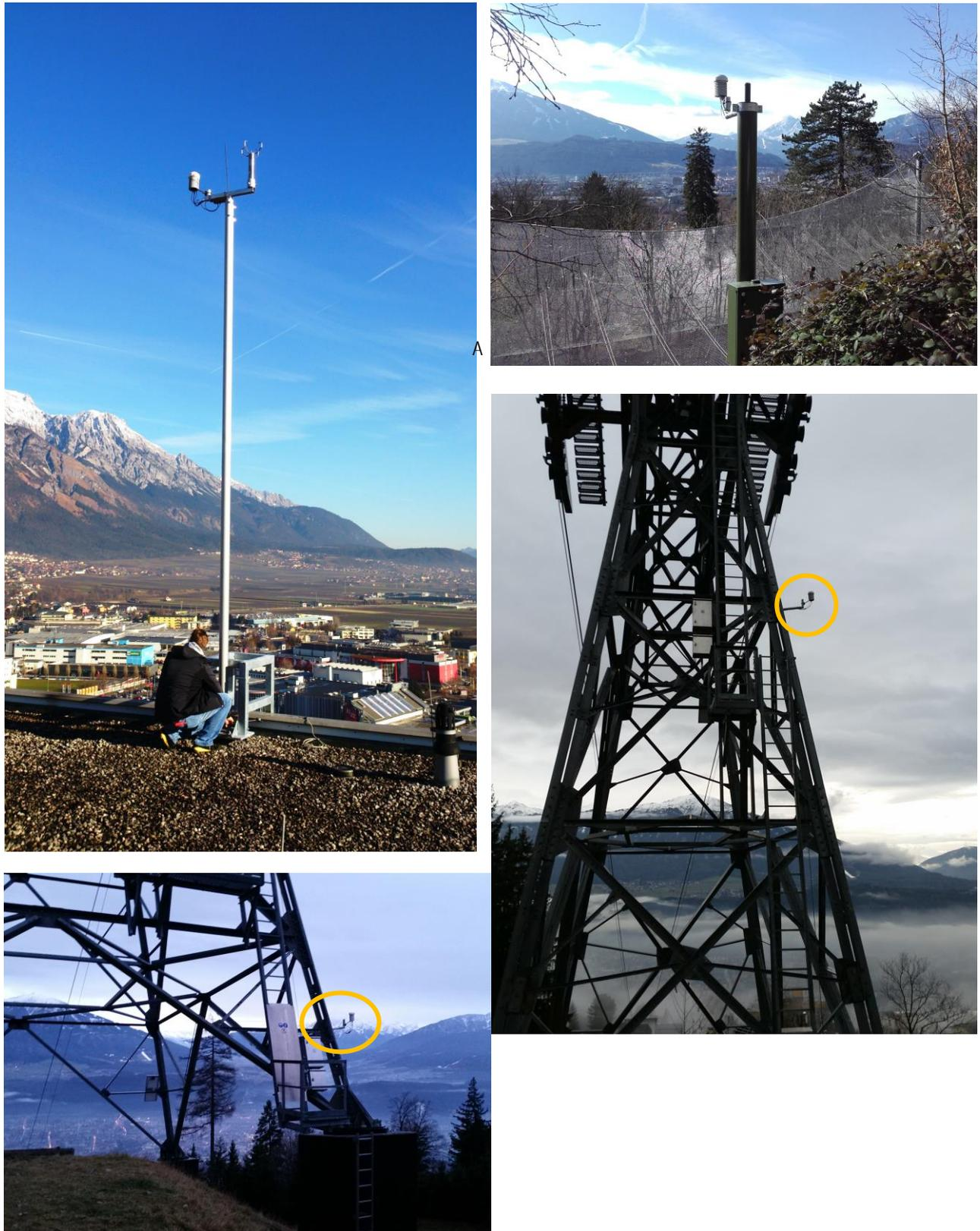
Abbildung 7-6: Die TEMPIS-Stationen Olympisches Dorf(links oben), Alpenzoo (rechts oben), Hungerburg (rechts unten) und Rastboden (links unten) ab 2015 nach der derzeit letzten Erneuerung. Die Temperatursensoren sind nun alle ventiliert. Die Messinstrumente der Stationen Hungerburg und Rastboden befinden sich deutlich weiter unten (mit gelben Kreisen markiert) auf den beiden Masten der Nordkettenbahn.
