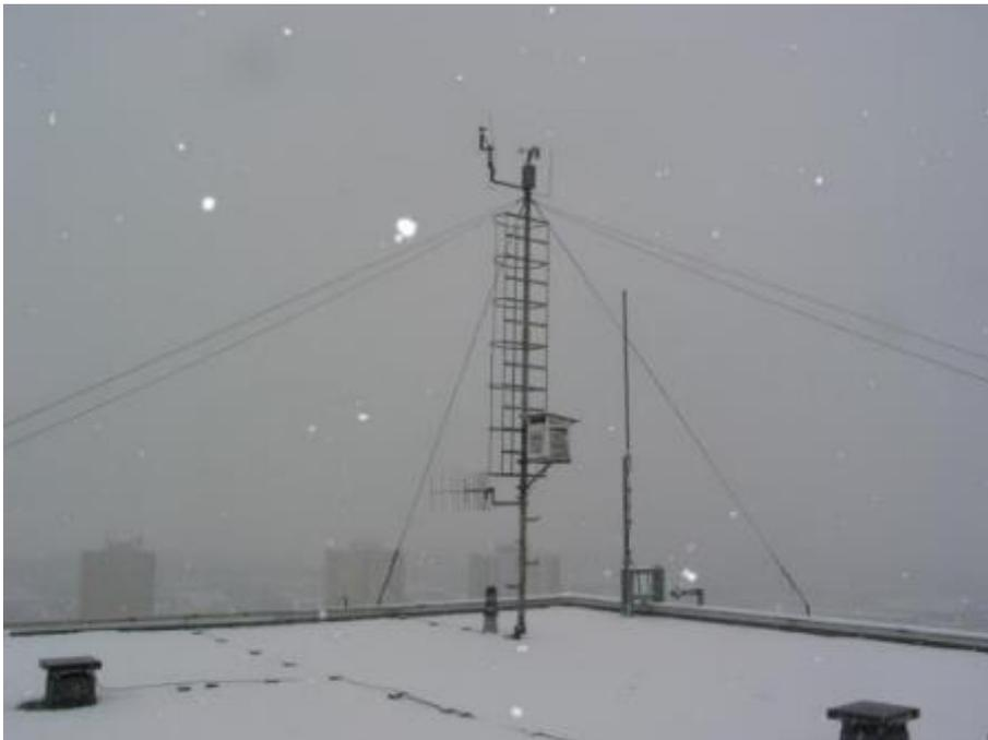
Abbildung 7-2: Standort der TEMPIS-Station Olympisches Dorf bis 2015. Die Wetterhütte wurde 2015 entfernt und der Wind- und Temperaturfühler auf einen 6 m hohen Masten am Dachrand verlegt.
