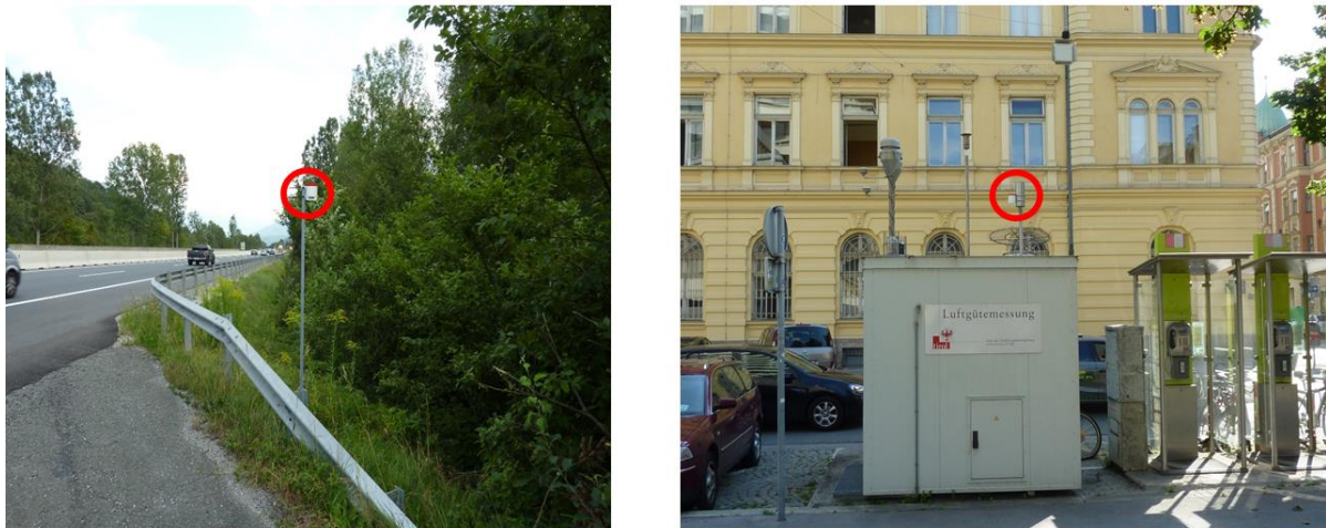
Abbildung 3-2. Beispiele für typische Messstandorte im Passivsammler-Messnetz. Links: Messstelle Zirl Dirschenbach A12 (km 93,3) als verkehrsnaher Standort. Rechts: Referenzmessstelle Innsbruck Fallmerayerstraße, mit Anbringung des Passivsammlers neben der Ansaugöffnung des kontinuierlich messenden Messgeräts APNA 370 für die \text{NO}_2 -Referenzmessung. Die roten Kreise heben die Passivsammler in den Fotos hervor.
