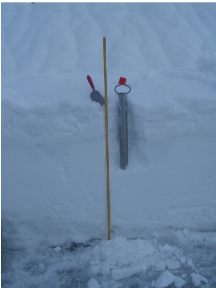
Die Ermittlung des Schneewasserwertes (SWW) erfolgt mit Schneeausstecher, Kelle, Waage und Messstab; hier im Areal der Deponie Lavant/Osttirol
