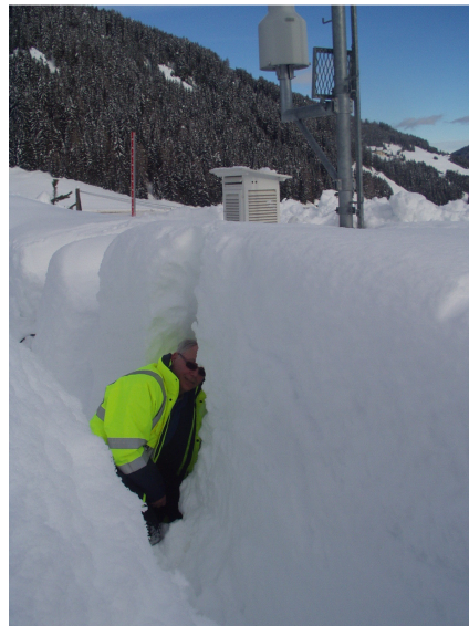
Mit dem Stechzylinder wird die Schneedecke im natürlichen Lagerungszustand von der Oberfläche bis zum Boden abgestochen und werden der Schneewasserwert und die Dichte der ausgestochenen Schneeschichten mit Hilfe einer Waage ermittelt; hier: Messstelle Obertilliach/Osttirol
