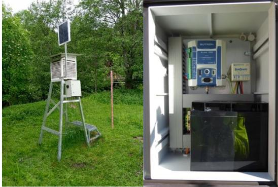
Fotos Hydrographischer Dienst, Land Tirol; Wetterhütte zur Beobachtung von Lufttemperatur, Schneepegel; Schaltschrank mit Datenerfassungsgerät, Übertragungseinheit und Stromversorgung
