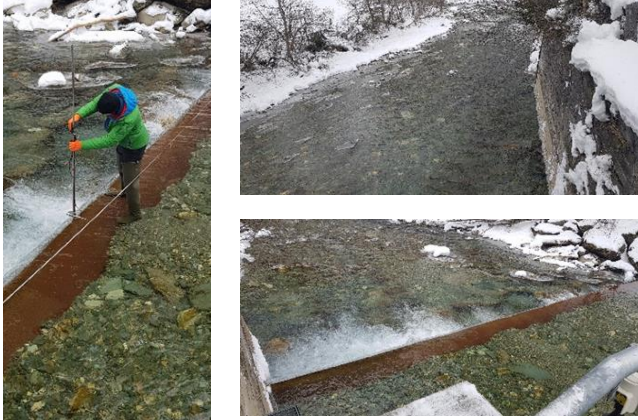
Foto: Hydrographischer Dienst, Land Tirol; Pegel Hinterbichl / Isel, Profilvermessung
