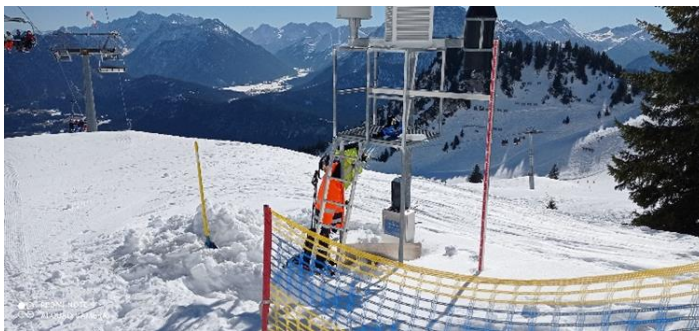
Schacht graben zur Schneeeentnahme mittels „Schneeausstecher“ (Probenzylinder) am Hahnenkamm (Reutte)
