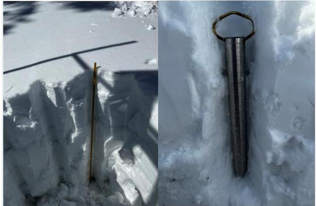
Abbildung, Fotos: Hydrographischer Dienst, Land Tirol: Aufzeichnung berechnetes Schneewasseräquivalent aus „ANAVS-Messungen“ überprüft mit Handmessungen am 7.2.2023, 1.3.2023 und 16.3.2023 mittels Schneeausstecher.
