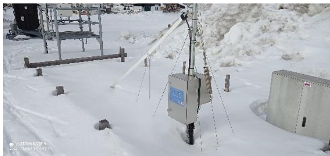
elektrische Schneedichtemessung Hochfilzen
