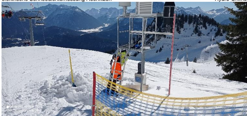
Schacht graben zur Schneeentnahme mittels „Schneeausstecher“ (Probenzylinder) am Hahnenkamm (Reutte)
