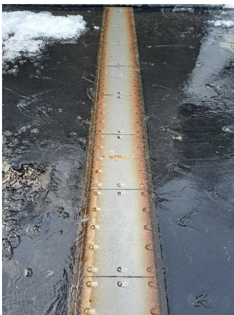
Foto: Land Tirol, Hydrographischer Dienst; Geophonanlage Messbalken (linkes Bild), geöffnete Schwebstoffsonde (rechtes Bild)
