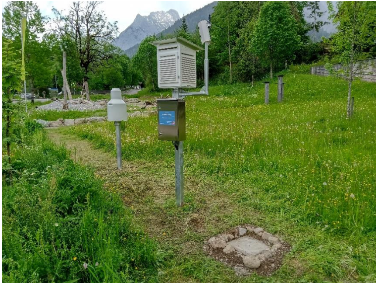
Foto: Hydrographischer Dienst, Land Tirol; Hydrometeorologische Messstelle Hinterriß mit Wetterhütte, Schneehöhensensor, Globalstrahlungssensor und Ombrograph (Niederschlagswaage)
