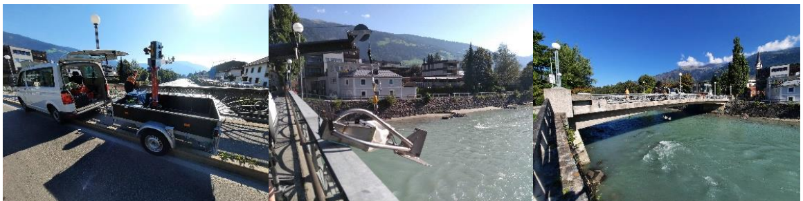
Foto: Land Tirol, Hydrographischer Dienst; mittels einer mobilen Seilkrananlage und einem „Geschiebefänger“ wird durch Absenken in den Fluss sohlennahe an mehreren Punkten das Geschiebe entnommen (Messung durch BOKU).
