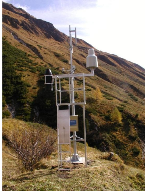
Detailansicht der Messstelle (roter Kreis im linken Bild) mit Niederschlagswaage, Totalisator, Sensorik für Schneehöhe und Lufttemperatur sowie Solarpaneel und Antenne für die Datenfernübertragung
