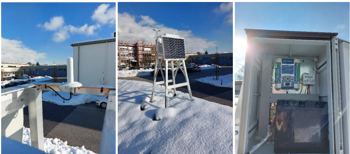
Fotos: Land Tirol, Hydrographischer Dienst; Testanordnung: Satellitenantenne (linkes Bild), Solarstromversorgung (Bildmitte), Datenerfassungseinheit (rechtes Bild)
