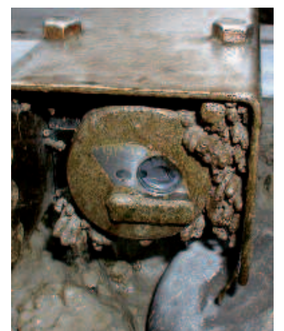
Trübungssonde mit Optik und Scheibenwischer
