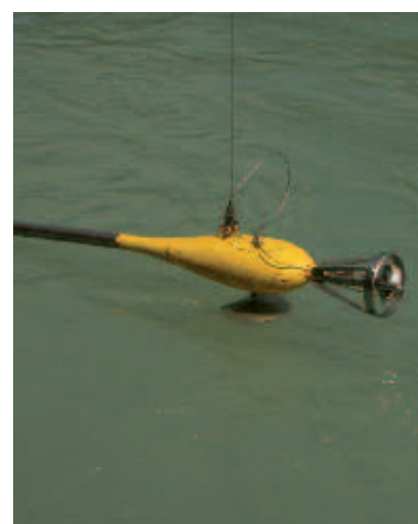
Hydrometrischer Flügel am 100 kg-Mittelstück der Messeilbahn
