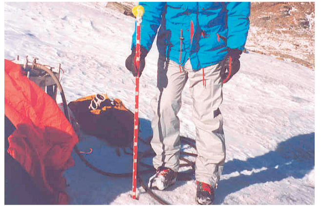
Mit dem Dampfbohrer werden im Spätsommer mehrere Meter tiefe Löcher vertikal in das Eis gebohrt, in welche die meterlangen Schneepegel gesteckt werden.
