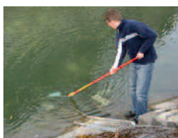
Durchflussmessung mit dem Hydrometrischen Flügel
